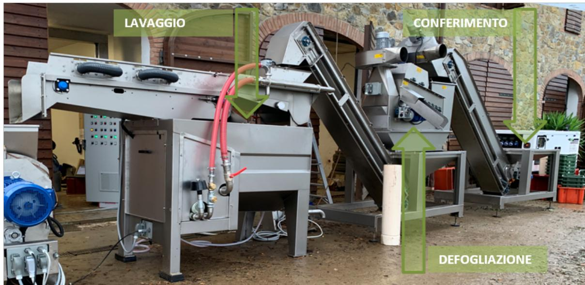
**Figura 3.** Linea di pulizia delle olive.
