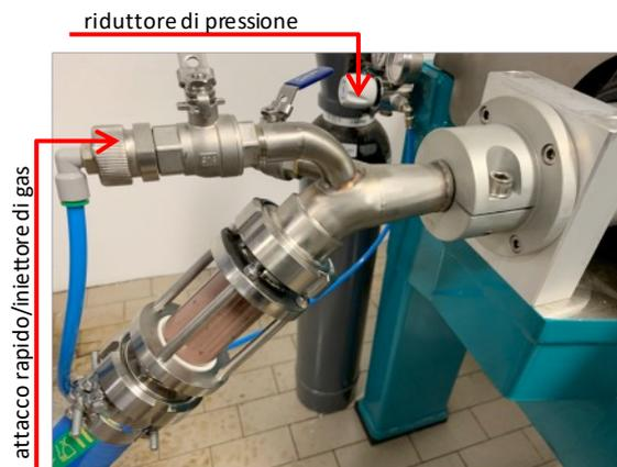
**Figura 7.** Decanter prototipo.
