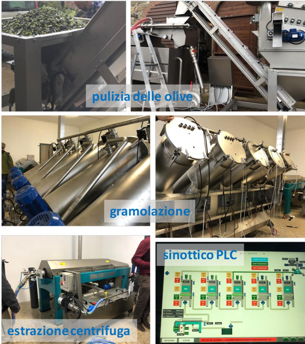
**Figura 2.** Alcuni particolari dell'impianto di estrazione.
