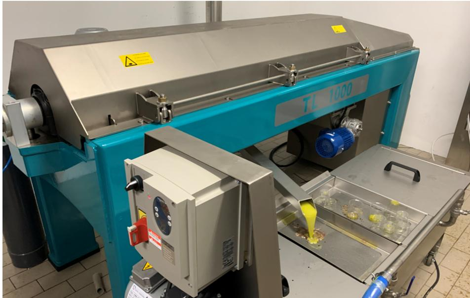
**Figura 6.** Decanter prototipo.
