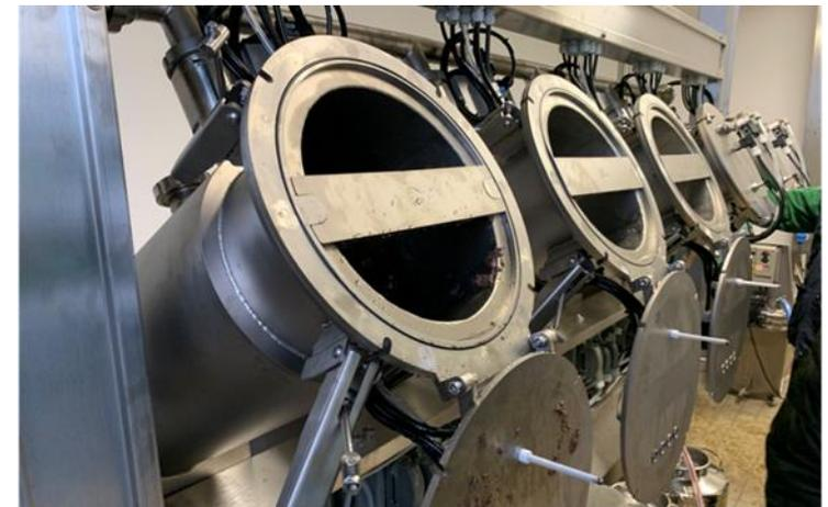
Nell'immagine è possibile vedere un particolare della chiusura superiore di uno dei 5 elementi di gramolazione. Si tratta di una portella circolare in acciaio inox dotata degli alloggiamenti per i sensori di livello della pasta e della temperatura.
