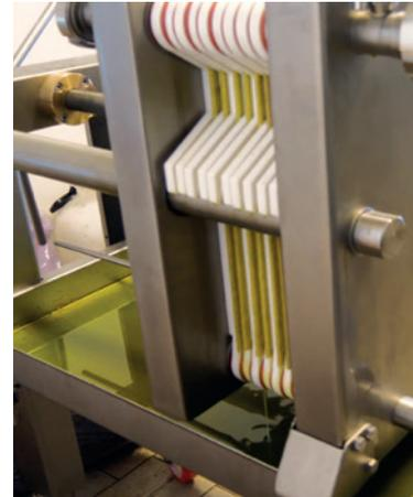
Sistema di filtrazione e piastre filtranti prototipo
